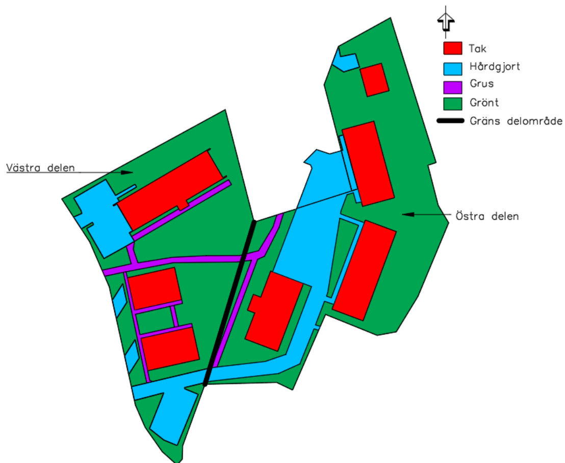
Figur 4. Indelning av utredningsområdet som används i avrinningsberäkningen. De ytor som har använts i beräkningen för den västra delen ligger till vänster av den streckade svarta linjen. Övriga ytor ingår i den östra delen i avrinningsberäkningarna (Situationsplan, Amok arkitektur AB 2018-01-30).
